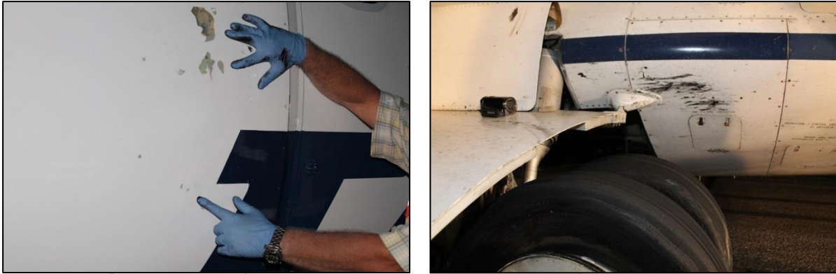
Fig.3 Urme de lovituri cu resturi de anvelope, pe fuzelaj.
