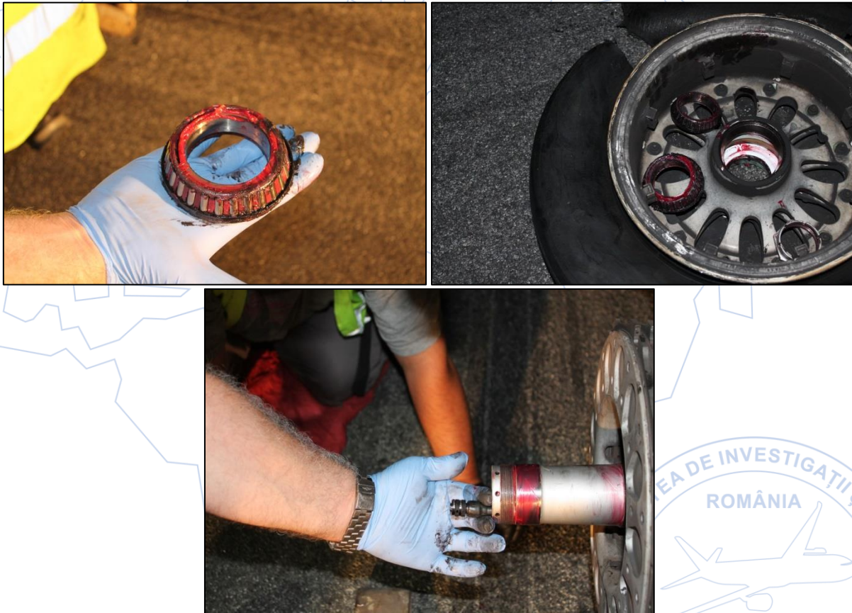
Fig.15 Rulmenți și ax roată fără neconformități
